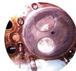
Ряд цилиндров и поршней вспомогательного двигателя после применения Адизоль Т-6
